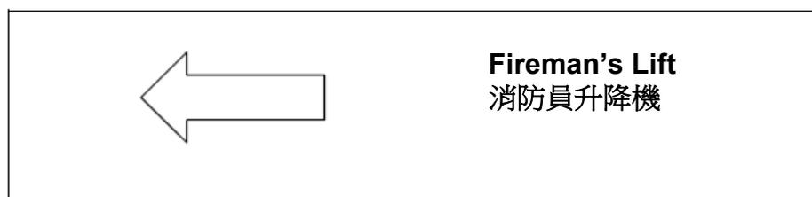
告示上字體的高度不應少於 20 毫米。該告示應由兩套獨立的電燈系統照明，或告示應是自行發光而無須使用外來電源的安全指示牌。
