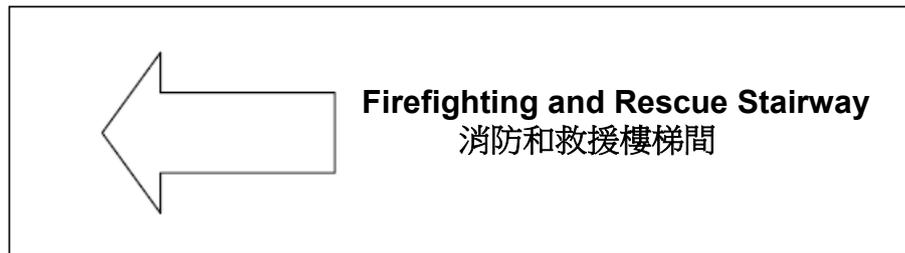
告示上字體的高度不應少於 20 毫米。該告示應由兩套獨立的電燈系統照明，或告示應是自行發光而無須使用外來電源的安全指示牌。
